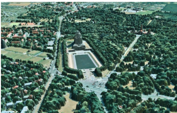
Mit dem Digitalen Orthophoto texturiertes DOM1 im Bereich des Völkerschlachtdenkmal in Leipzig
